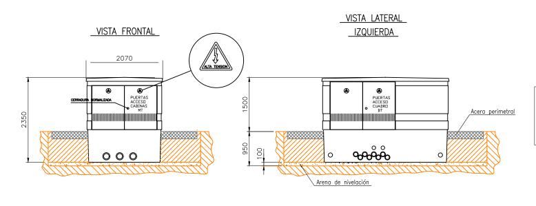
DIMENSIONES DE LA EXCAVACION 5,675 m. ancho x 4,27 m. fondo x 0.95 m. profundidad
