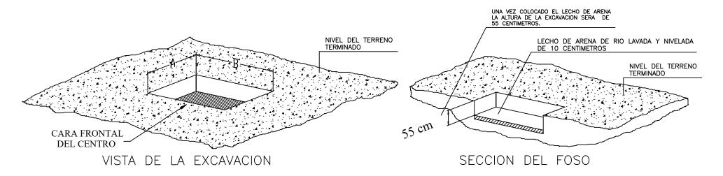
SITUAR EL MODULO DE HORMIGON CENTRADO EN LA EXCAVACION, DEJANDO 50 cm. POR SU FRENTE Y SU PARTE POSTERIOR, PARA PERMITIR LA EXTRACCION DE LOS UTILES DE IZADO.
