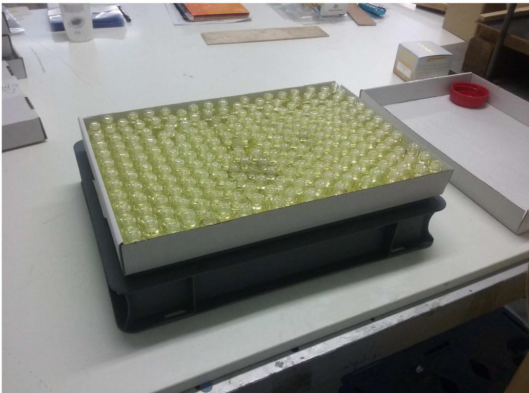
Figura 38 - Bandejas auxiliares para la acomodación según la altura de trabajo de cada operaria
