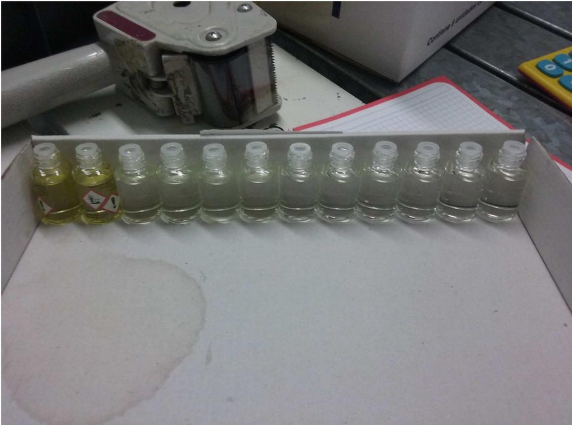
Figura 37 - Unidades desechadas por mezcla de líquidos durante el cambio de fragancia en la jeringuilla
