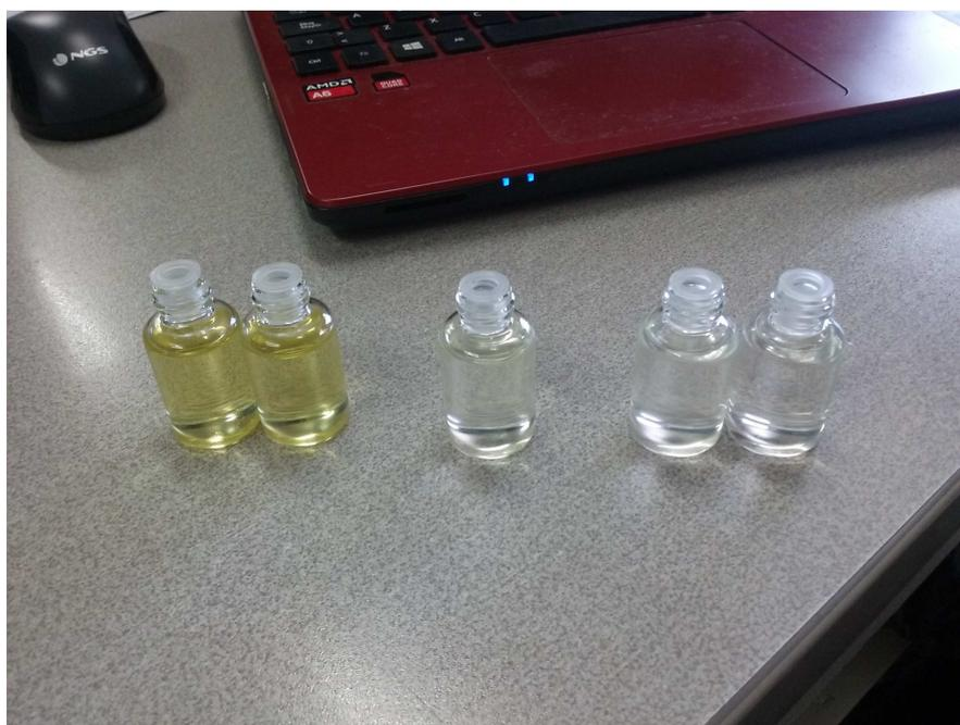
Figura 36 - Unidades desechadas por depósitos de impurezas en el líquido ambientador durante la noche
