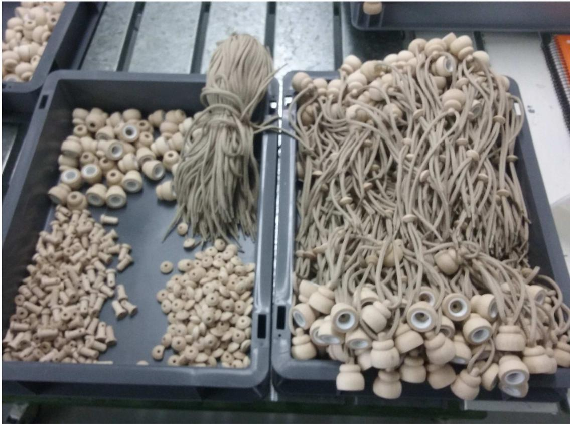
Figura 28 - Sistema inicial de montaje del tapón
