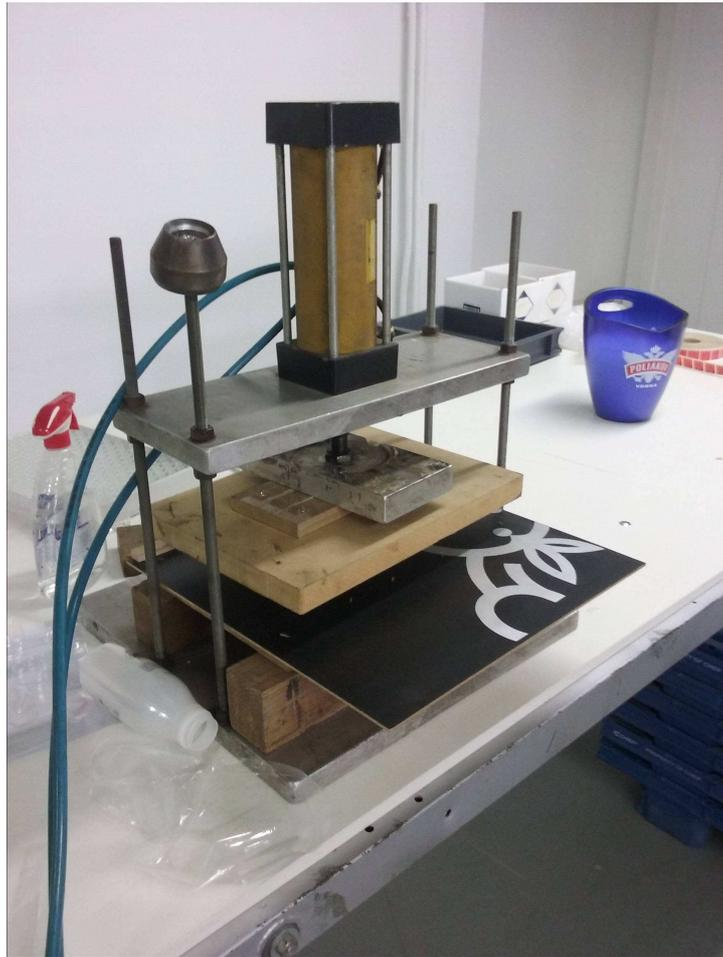
Figura 40 - Prensa hidráulica para el taponado
