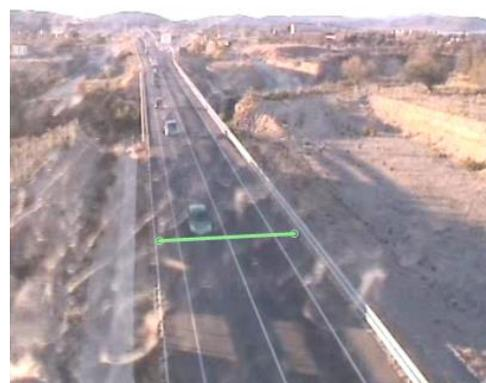
Figura 34. Línea para medir intervalos en la CCTV21
