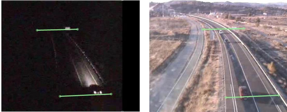
Figura 35. Líneas para medir intervalos y velocidad en CCTV22
