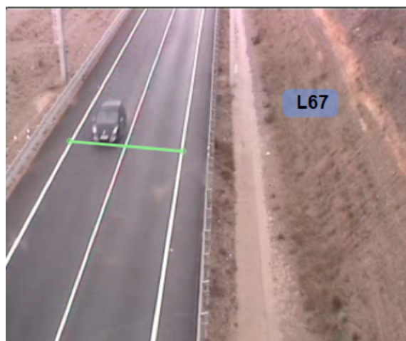
Figura 27. Programa KINOVEA cálculo de la velocidad, CCTV21 dirección Valencia en condición de lluvia
