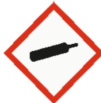
*Figura 5. Pictograma gases a presión. Fuente: Ficha de Seguridad del Amoníaco.*
