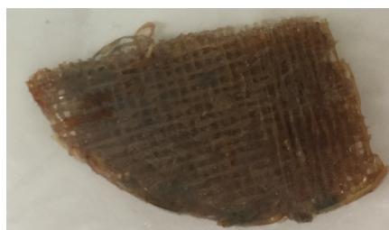
Figura 45. Porción del scaffold de PGS obtenido por plantilla porogénica de PVA.
