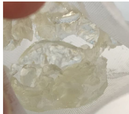
Figura 41. Muestras de la experiencia 2 con PMMA tras el proceso de lavado.
