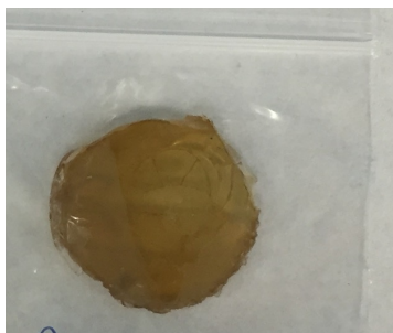
Figura 32. Muestra de la experiencia de naftaleno con n-octano y PGS para la técnica de separación de fases con porosidad estimada de 80 %.
