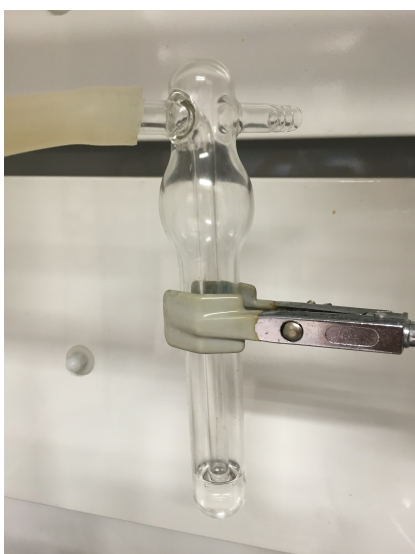
Figura 10. Detalle de la trampa de nitrógeno.
