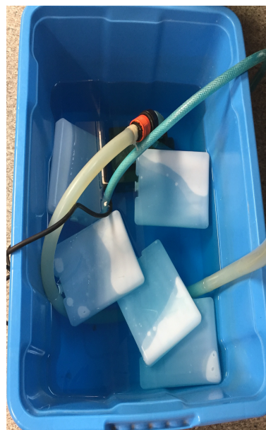
Figura 15. Bomba para circuito de refrigeración.
