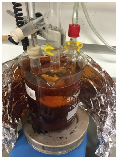
Figura 11. Detalle del montaje del baño termostático.
