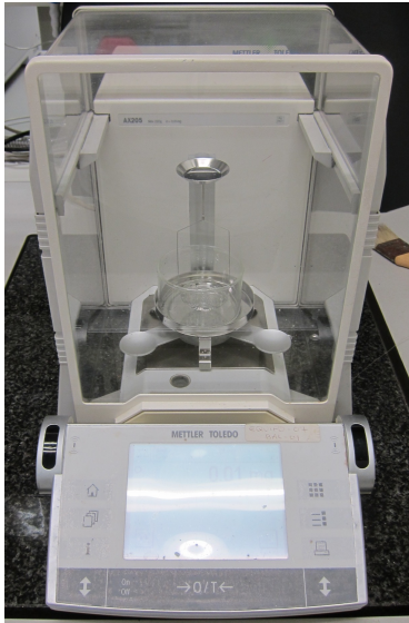
Figura 17. Balanza de precisión montada con el kit de ensayo de densidad.
