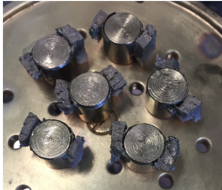
Figura 25. Portamuestras cilíndricos con las muestras tratadas con oro colocadas en los laterales, para poder observar su sección.
