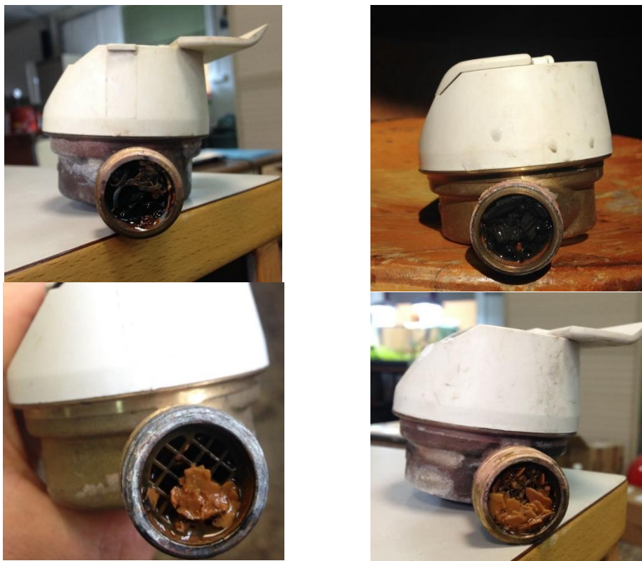
Figura 48 Taponamiento en el filtro que daba lugar a sobrecontaje
