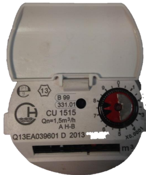
Figura 1 Aspecto del contador ensayado. Marcación
