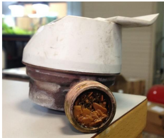
Figura 29 Taponamiento del filtro del contador identificado con C4
