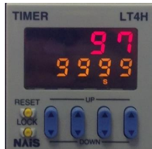
Figura 18 Cronómetro utilizado. Se detiene al llegar el agua al nivel indicado en las reglas
