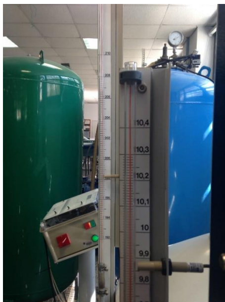
Figura 17 Reglas para medición de volumen aforado
