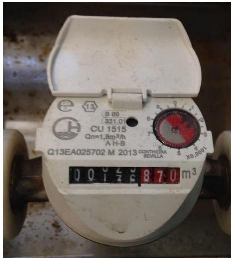
Figura 23 Rodillos mal sincronizados
