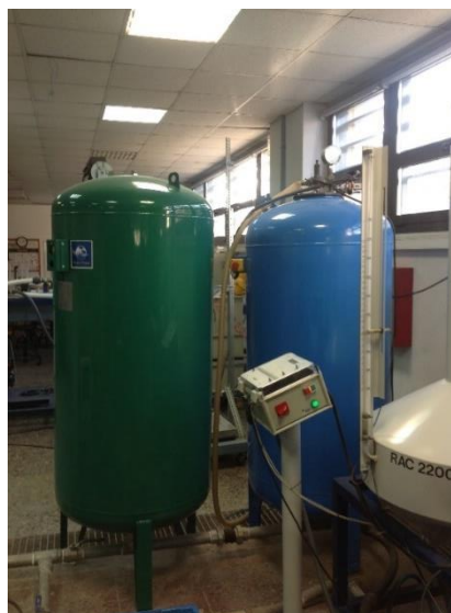
Figura 20 Calderines para mantener un flujo estable
