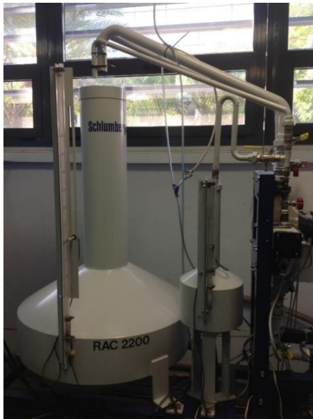
Figura 16 Tanques de almacenamiento para comparación del volumen aforado
