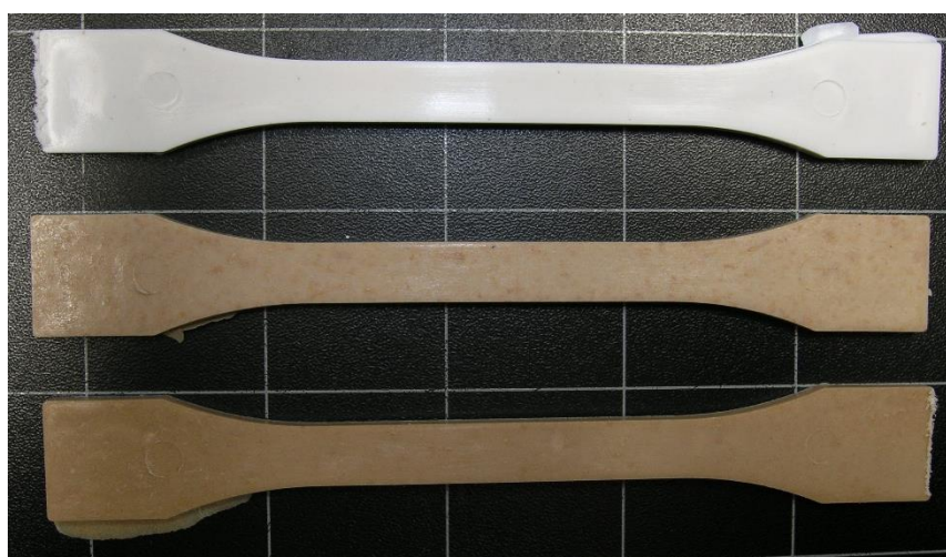
Figura 56. Aspecto de muestras de PLA (superior), PLA-45WG (central) y PLA-45WG-20ELO (inferior)
