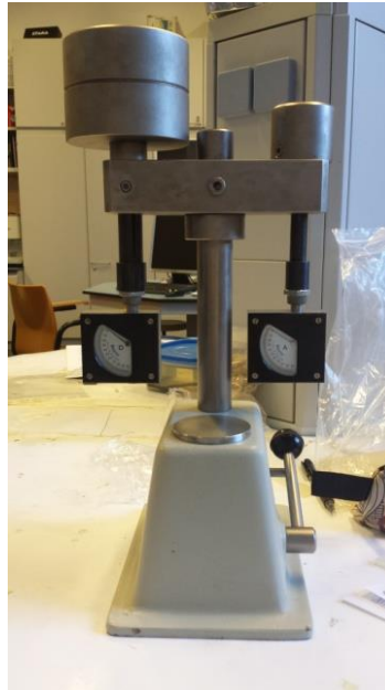
Figura 36. Durómetro Shore de JBA S.A. Modelo 673-D.
