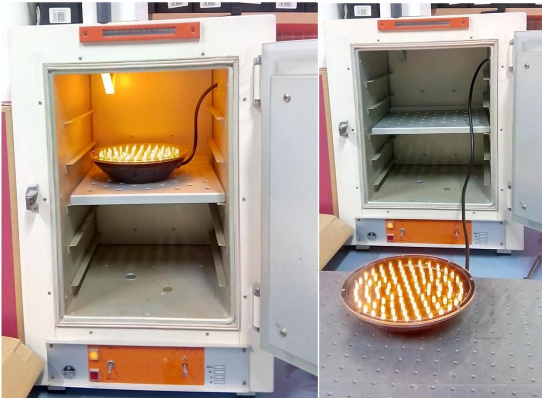
**Figuras 13 y 14. Montaje medición disco led ámbar.**
