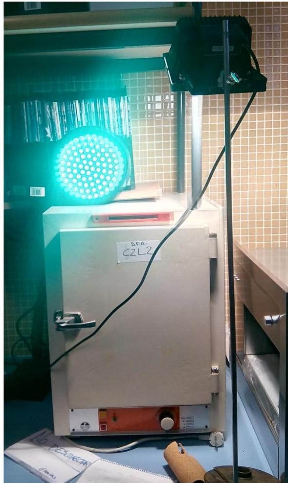
**Figura 15. Montaje medición disco led verde.**
