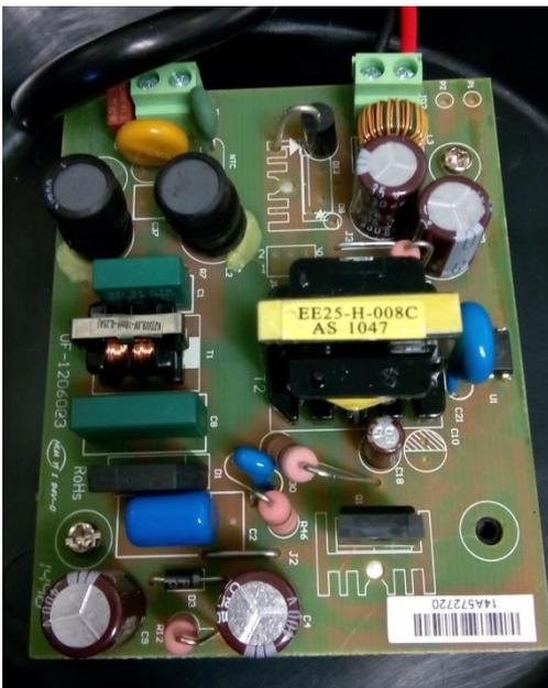
Figura 8. Circuito disco diodo led.
