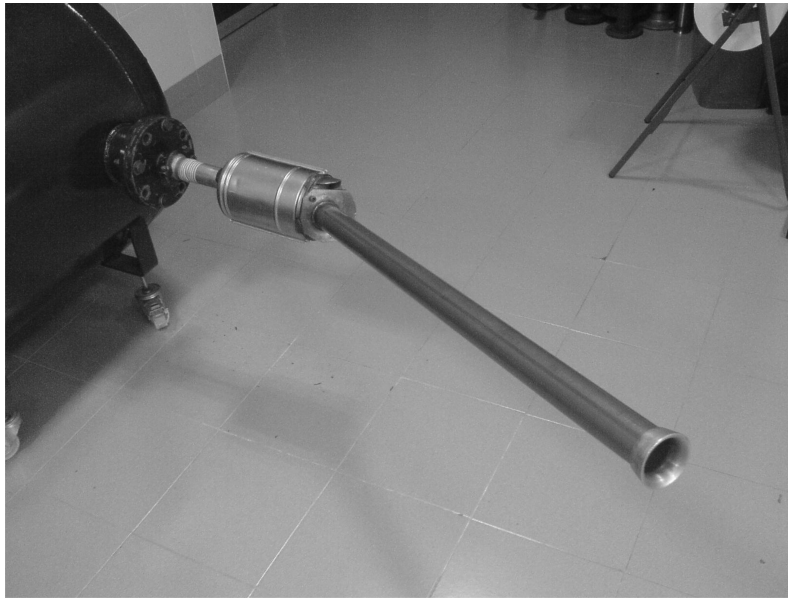
Figura 4.9. Instalación del filtro de partículas en el banco de flujo.
