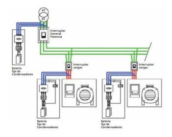
Tensión, debiéndose compensar en esta situación, la energía reactiva del mismo. Es aconsejable la colocación de seccionadores en carga para la eventual sustitución de fusibles.
