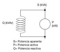
Los capacitores generan energía reactiva de sentido inverso a la consumida en la instalación. La aplicación de éstos neutraliza el efecto de las pérdidas por campos magnéticos. Al instalar condensadores, se reduce el consumo total de energía (activa + reactiva), de lo cual se obtienen varias ventajas
