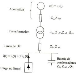
Imagen 9 Esquema unifilar simplificado de la instalación
