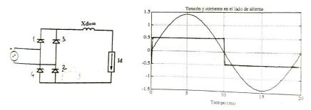
Imagen 10 Esquema eléctrico diodo monofásico
