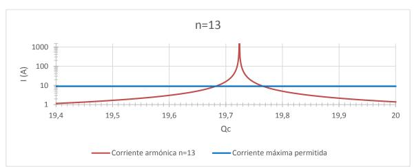
Gráfico 2 Relación de la potencia de la batería de condensadores con la Tasa de distorsión armónica para n=13
