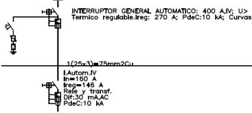
Imagen 4 Interruptor Automático de la instalación
