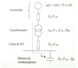
Imagen 7 Diagrama unifilar simplificado de la instalación
