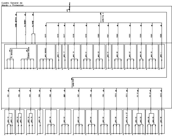
Imagen 1 Esquema unifilar de la instalación
