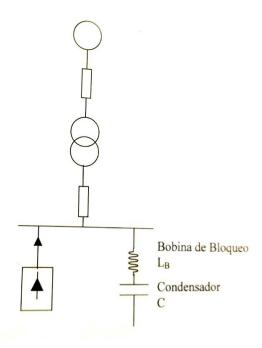
Imagen 8 Diagrama de la instalación. Bobina de bloqueo.
