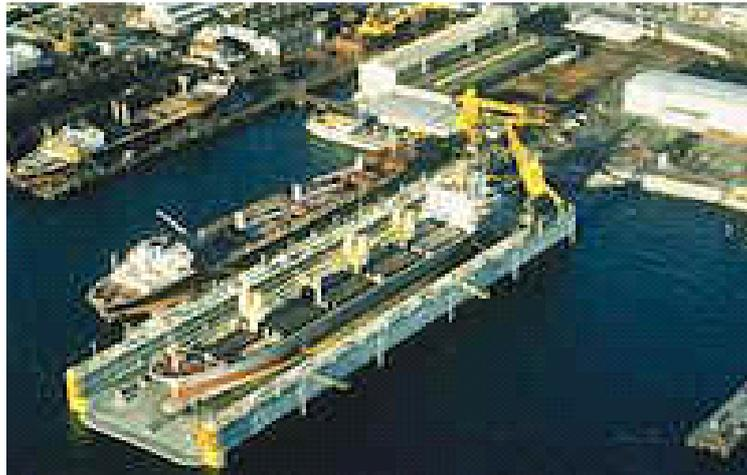
Figura 3.7: Distribución por posición fija, montaje naval.
