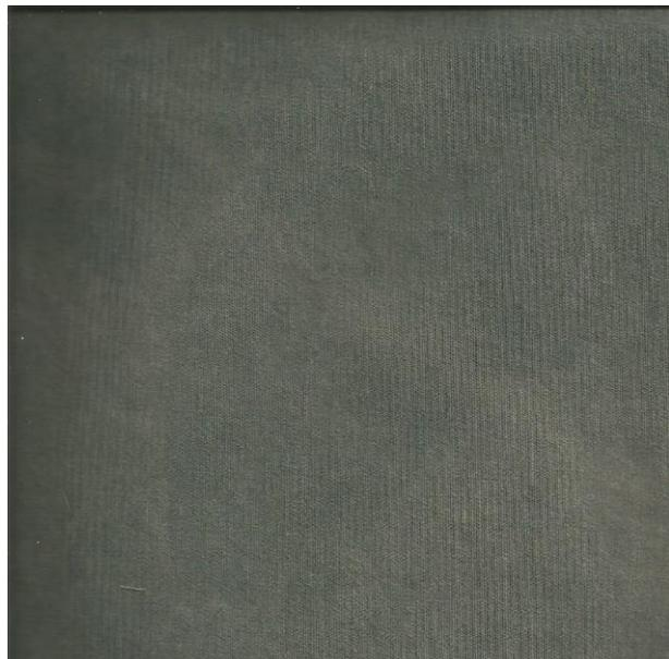
La diferencia principal de color tras el acabado por corrosión, reside en que el tratamiento realizado por baño tiene un resultado uniforme en todo el tejido, toda la muestra queda descolorida por igual. Mientras que el acabado realizado mediante el sistema Ecofinish posee un acabado irregular, con diferentes zonas del tejido descoloridas proporcionando así un motivo de diseño.
