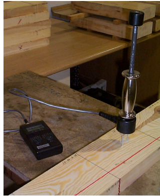
Figura 9.3.- Toma de lectura del CH con el higrómetro de puntos en el lote de 100 viguetas de Pinus radiata D. Don.
