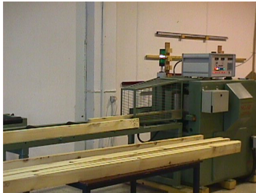
Figura 9.2.- Máquina clasificadora mecánica Cook-Bolinder (Laboratorio de estructuras de maderas CIFOR - INIA).
