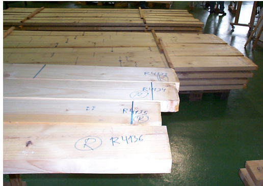
Figura 9.4.- Viguetas de Pinus radiata D. Don. clasificadas por la norma UNE 56544:2007. En la imagen se muestran las viguetas R4136 , R4135 , R4134 , R4133 en las que se marca el resultado de la clasificación: Rechazo (R).
