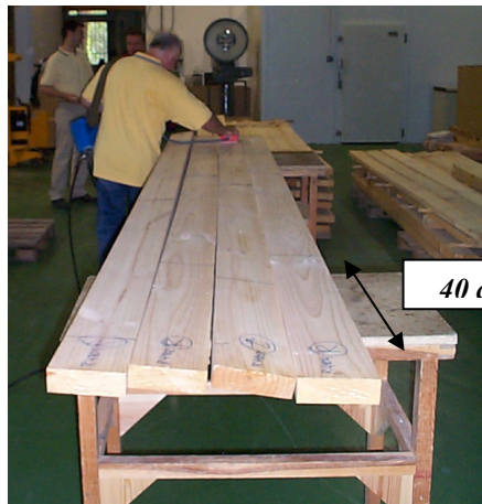
Figura 9.6.- Adquisición de registros con la antena de frecuencia central de 1.6 GHz (GSSI) en el Laboratorio de Estructuras de Madera de CIFOR-INIA (Madrid, España).
