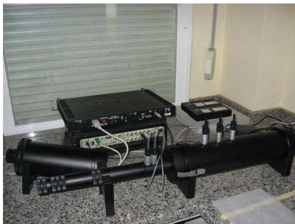
Figura 2. Detalle del equipo utilizado en la caracterización acústica de los diferentes materiales.
