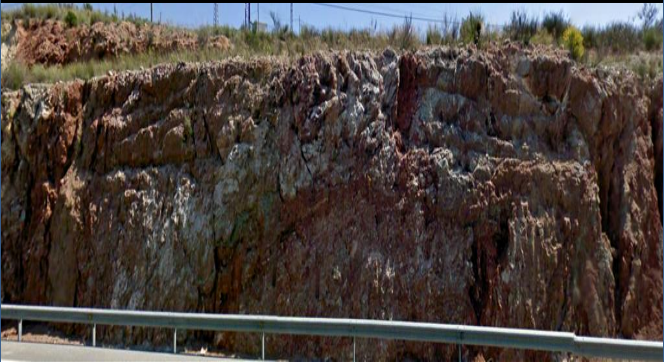
Detalle de una anterior. Arcillas versicolores y yesos del Keuper, Triásico Sup. Autopista Mediterráneo, Alicante. S y Hoja de Elda, (altura realzada)
