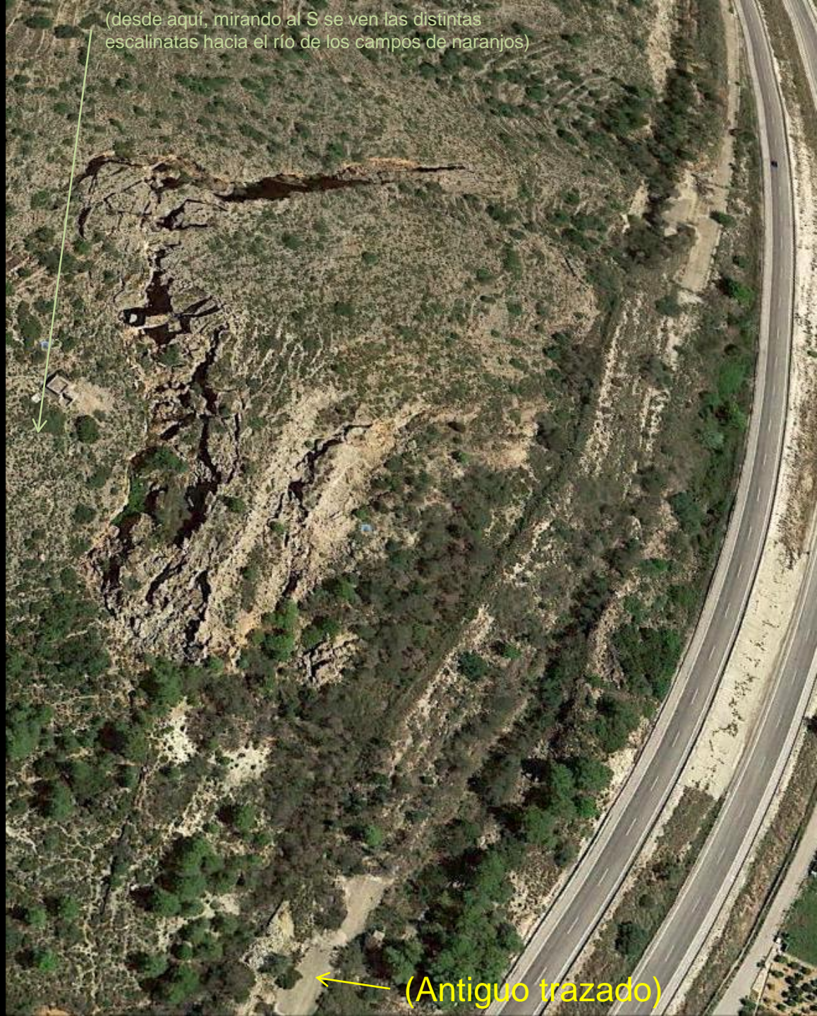
Deslizamiento de ladera sobre la Autopista del Mediterraneo. Dolomías del Kimmeridgiense, Jurásico. SE de Rafelcofer, Valencia. W Hoja de Gandía.
