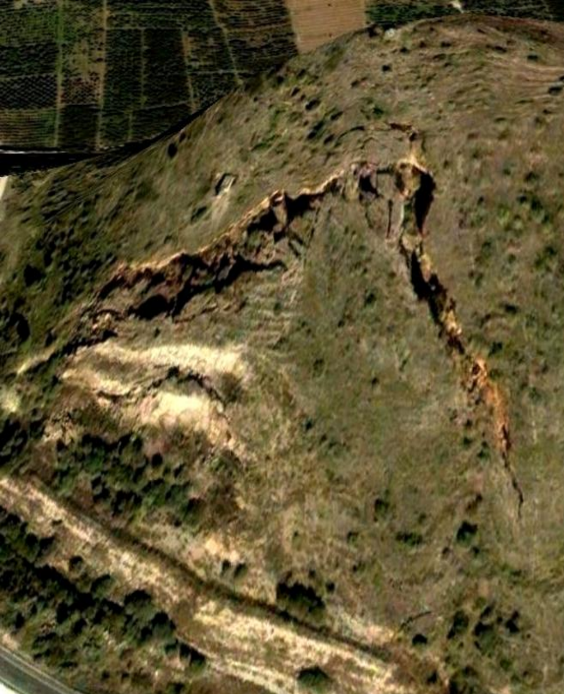
Deslizamiento de ladera sobre la Autopista del Mediterraneo. Dolomías del Kimmeridgiense, Jurásico. SE de Rafelcofer, Valencia. W Hoja de Gandía.
