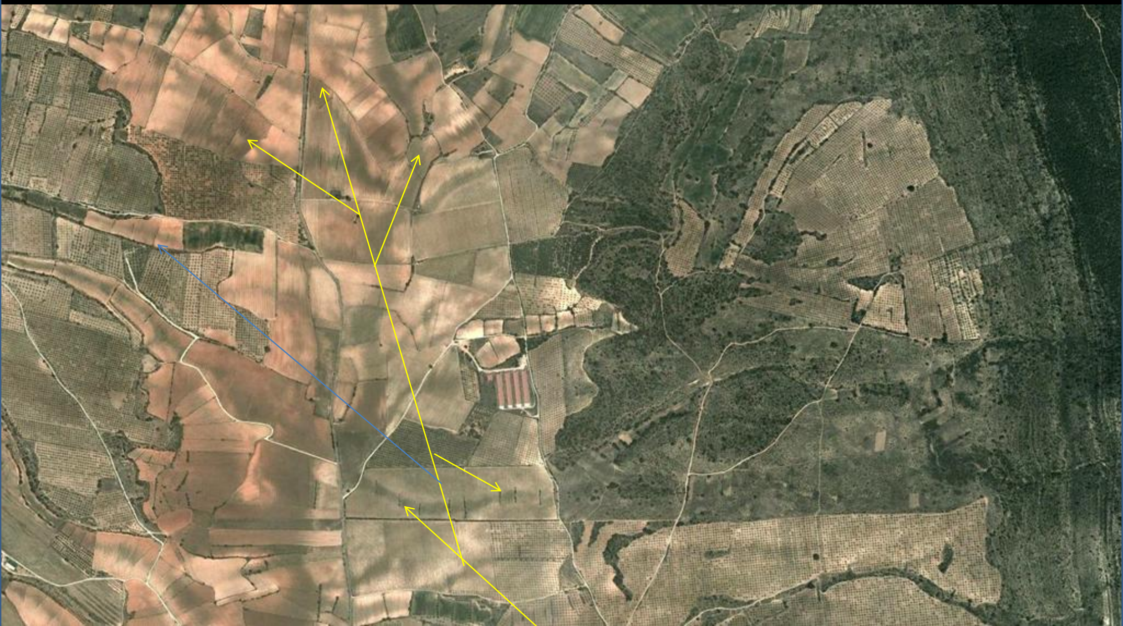
A la izq. Cuaternarios con niveles freáticos sub-superficiales. A la der. Cretácicos – con fuertes buzamientos hacia el E. -de La Sierra de La Bicuerca, NE de Fuenterrobles. Centro N Hoja de Utiel.
