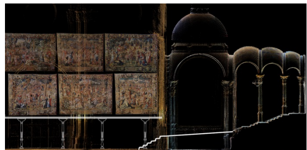
Figura 11: Reconstrucción digital de la empaliada original sobre nube de puntos de la sección transversal de la capilla de San Marcos. Basado en fotografía de la empaliada de 1919.
