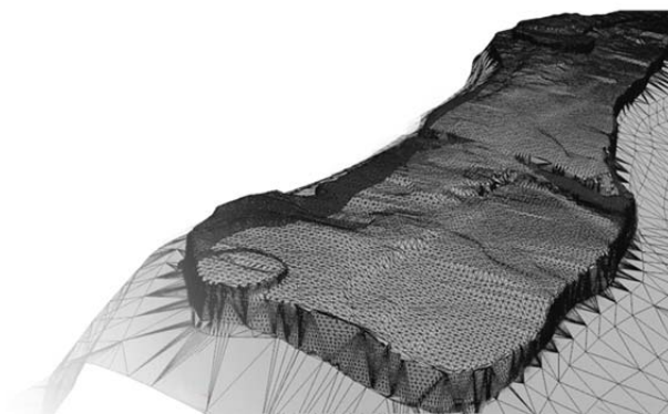
Figura 16: Malla triangular de la superficie de Kuélap sin estructuras obtenida con Rhinoceros
