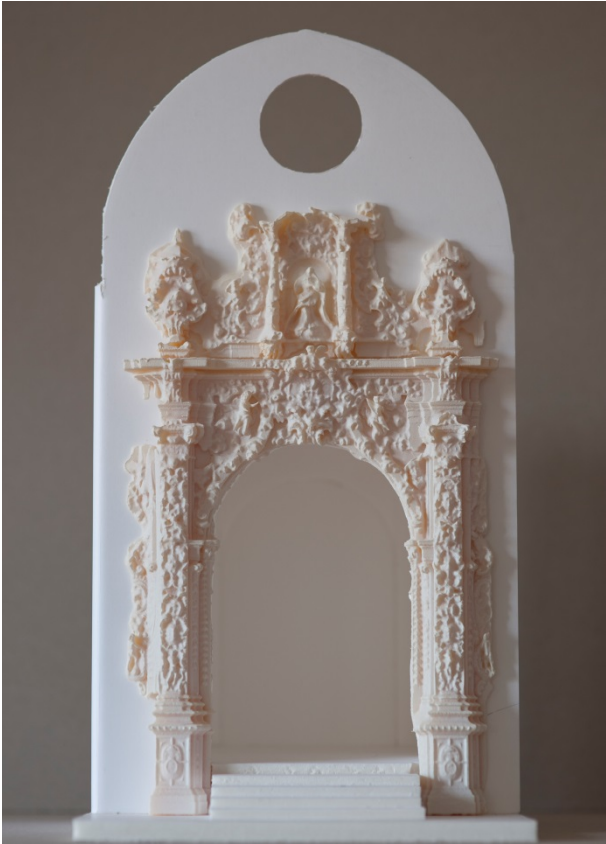
Figura 20: Maqueta a escala de la capilla de San Marcos con la portada impresa mediante técnicas de prototipado rápido (30cm x 20cm).
