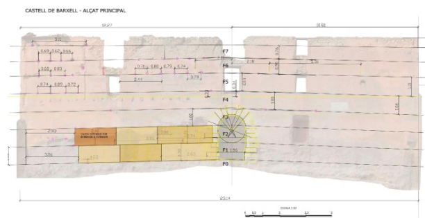
Figura 3: Fachada principal. Estudio de la tapia sobre alzado.
