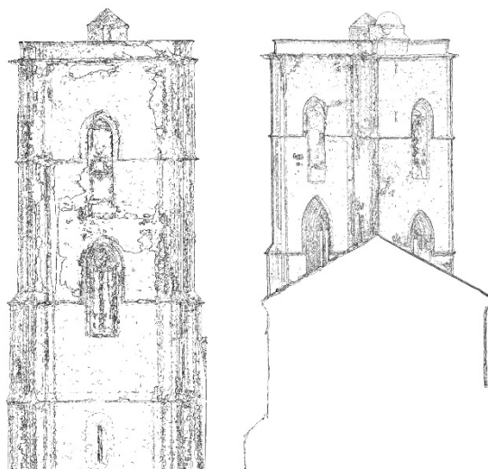
Figura 6: Alzados vectoriales en dwg a partir de la exportación de gráficos 2D de mallas suavizadas en Sketchup.
