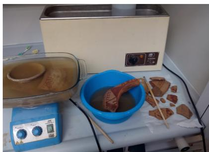
Figura 31. Limpieza por inmersión de todas las piezas en una disolución al 5% de EDTA bisódica y tetra sódica al 50%.
