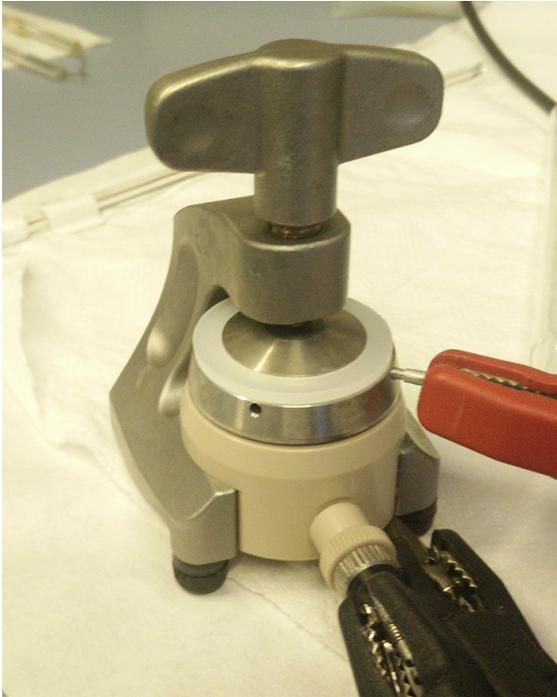
Figura 1.5: Celda de 3 electrodos EL-CELL<sup>®</sup> ECC-Aqu.
