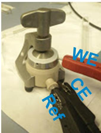
Figura 4.7: Celda EL-CELL ECC-Aqu conectada al galvanostato-potenciostato. WE: Electrodo de trabajo, conectado a la tapa; Ref: Referencia, conectado al electrodo de referencia; CE: Contra electrodo, conectado en la parte inferior de la base.
