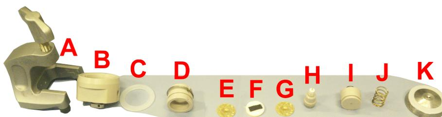
Figura 4.5: Partes de la celda EL-CELL ECC-AQU. A) Soporte. B) Base/Conector Contra electrodo. C) Junta. D) Manguito. E y G) Colectores. F) *Sandwich*. H) Electrodo de Referencia. I) Pistón/Electrodo de trabajo. J) Muelle de compresión. K) Tapa/Conector electrodo de trabajo.
