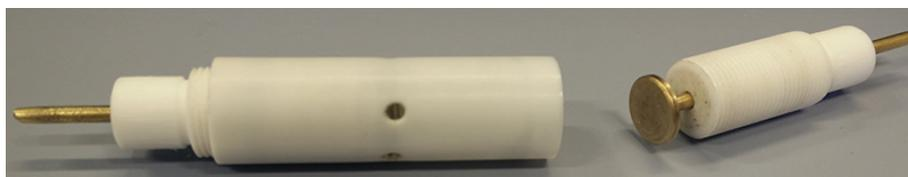
Figura 1.4: Celda de 2 electrodos de teflón para medidas en seco.
