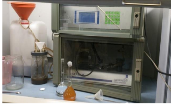
Figura 24. Equipo utilizado en el ensayo de respirometría por fangos activos.
