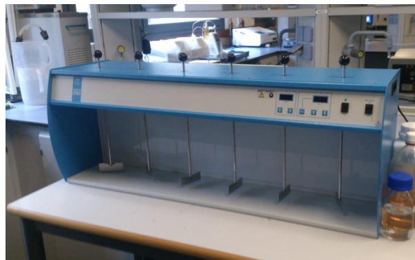
Figura 17. Agitador múltiple utilizado en el pretratamiento de floculación/coagulación
