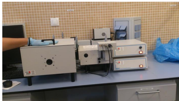
Figura 26. Equipo medidor de la fluorescencia de la muestra a analizar o fluorímetro.
