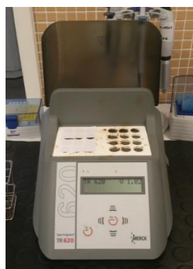
Figura 20. Termostato utilizado en la digestión de los tubos de test de DQO.
