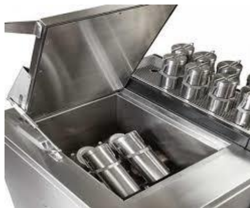
Figura 18. Equipo Gyrowash- empleado para ensayar la solidez al lavado
