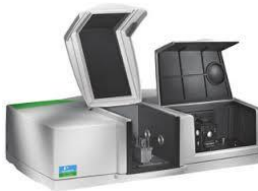
Figura 20. Espectrofotómetro Lambda 950- empleado para la determinación de los espectros de los tejidos
