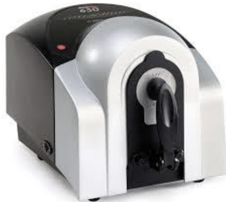
Figura 17. Equipo Datacolor DC650-empelado para las coordenadas CIELab
