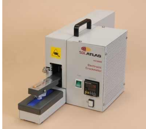
Figura 19. Aparato Crockmeter- empleado para ensayar la solidez al frote de los tejidos
