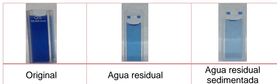
Figura 31. Imagen de las aguas tras la eliminación del colorante del baño de tintura - Arthrospira platensis (BEA0007)
