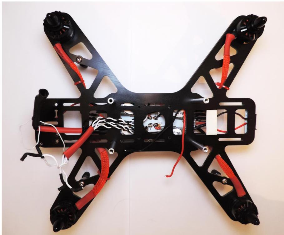
**Figura 23.** Montaje PCB y motores parte superior.
