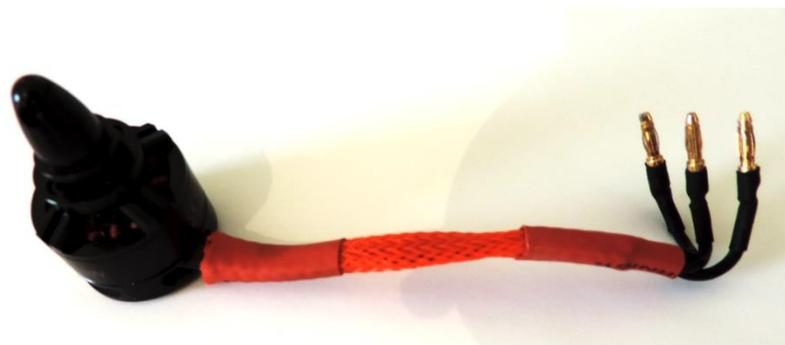
**Figura 21.** *Motor BE1806, cables cubiertos con malla de nylon.*
