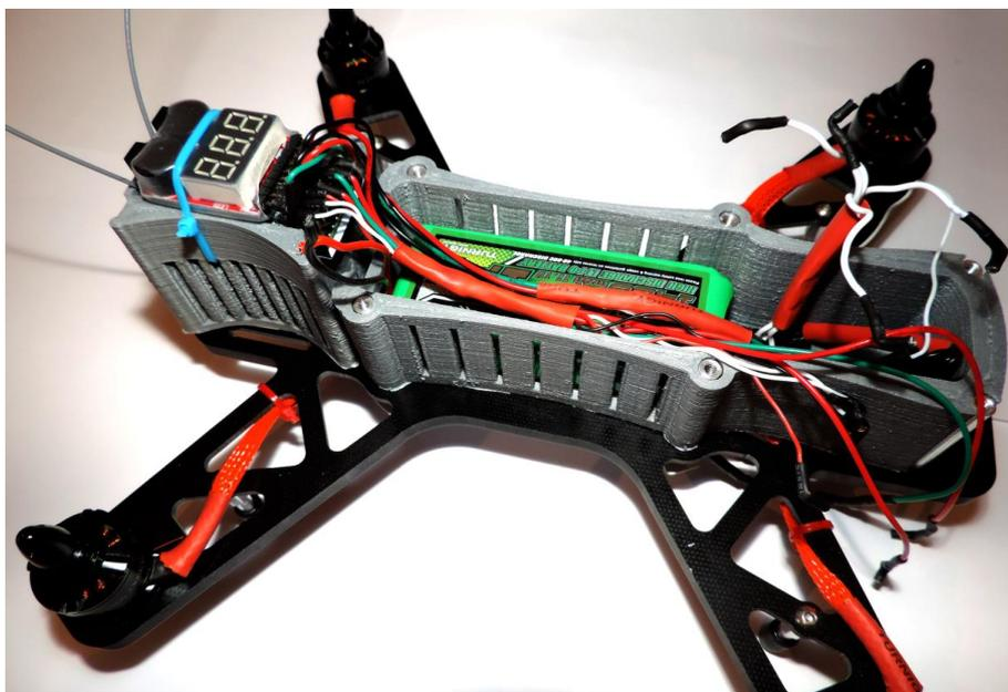
**Figura 25.** Colocación batería, soporte receptor y medidor de tensión.
