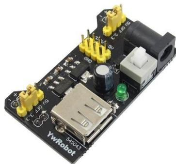
**Figura 9.** Regulador de tensión YwRobot 5 o 3.3 V.
