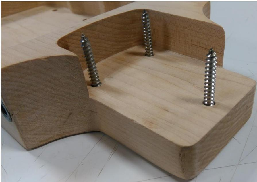
Figura 103: Tornillos sujeta mástil
