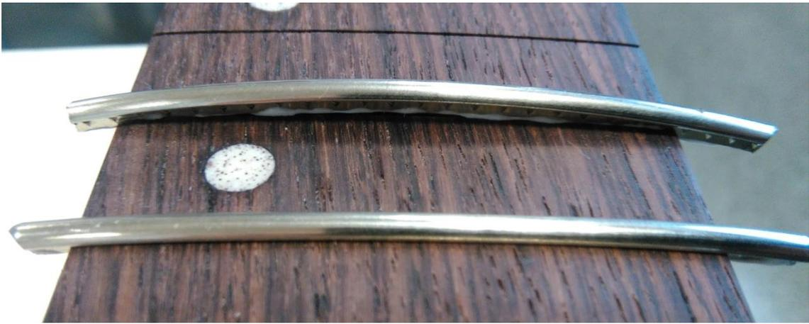
Figura 82: Montaje de los trastes sobre el diapasón
