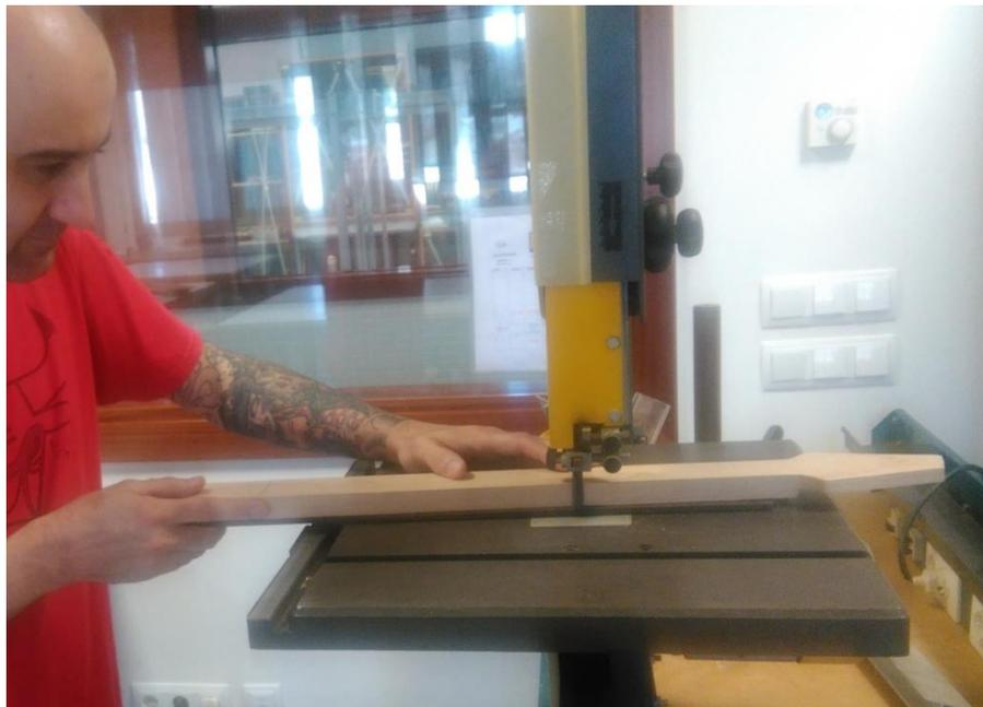
Figura 54: Eliminación del sobrante del diapasón
