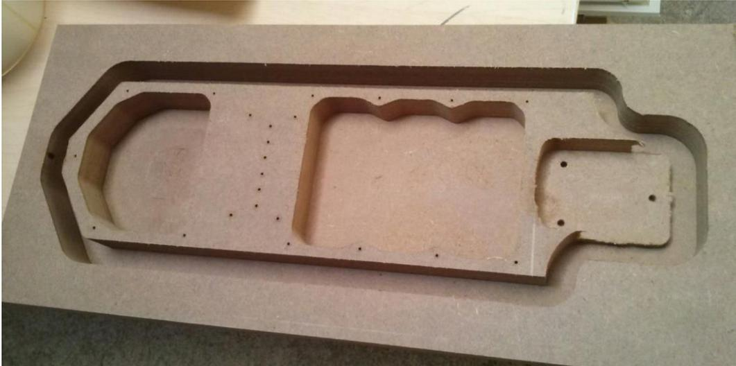
Figura 160: Núcleo de la guitarra en madera DM
