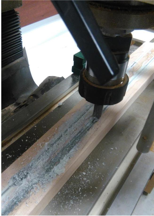
Figura 51: Fresadora trabajando en el mástil
