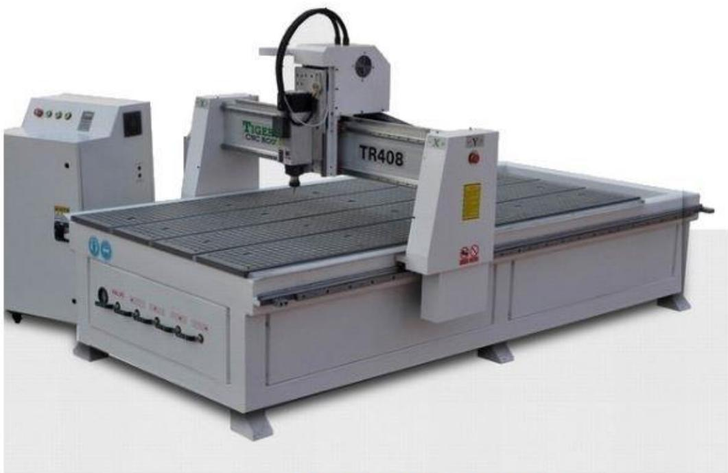
Router CNC para fresado y grabado de maderas y acrílicos.
