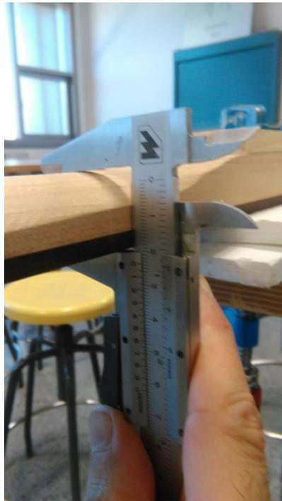
Figura 67: Verificación de espesor
