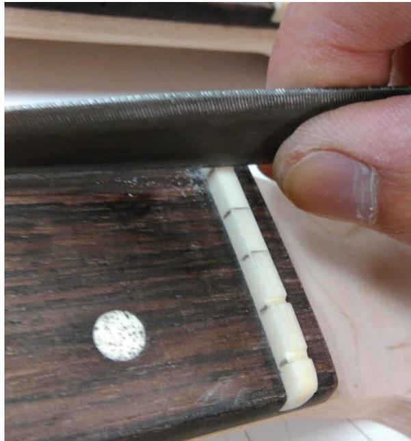
Figura 95: Marcado del hueco de las cuerdas
