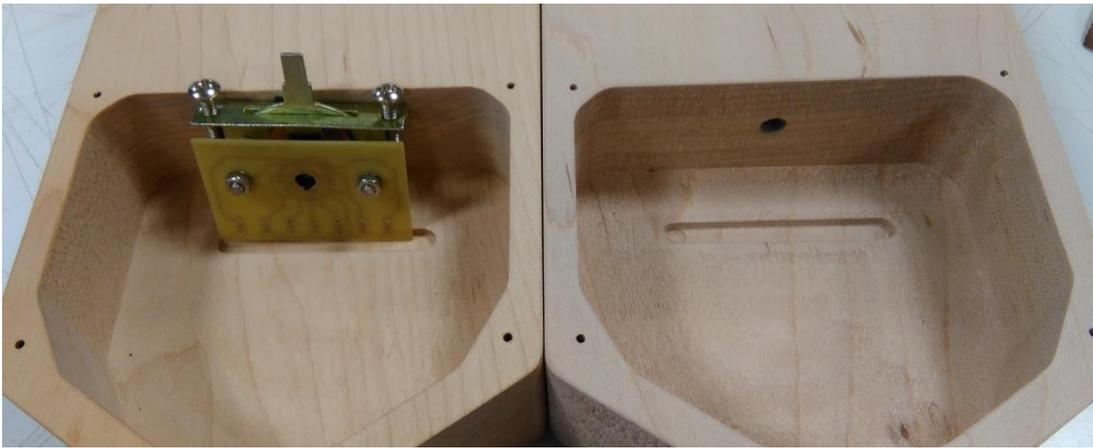
Figura 100: Ranura para el selector de pastillas
