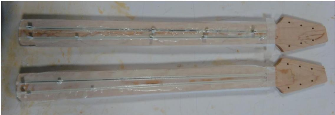
Figura 49: Mástiles con resina curada
