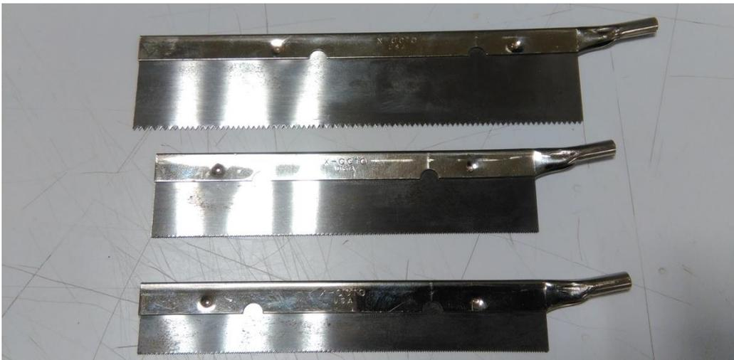
Figura 59: Sierras de diferentes espesores
