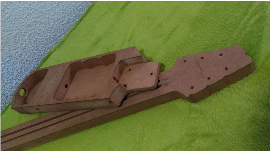
Figura 161: Mástil y núcleo en madera DM
