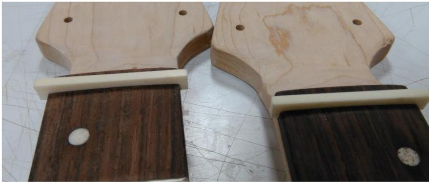
Figura 94: Cejillas con espesor óptimo
