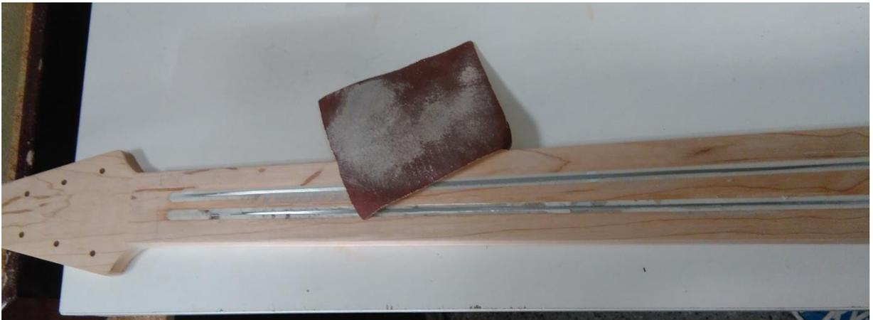
Figura 52: Lijado de la superficie
