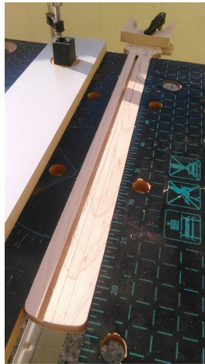
Figura 42: Fresado del mástil
