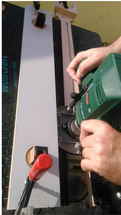
Figura 41: Fresado del mástil
