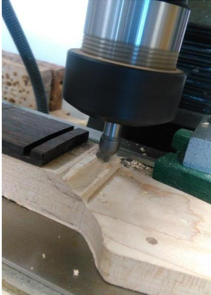
Figura 62: Fresado de la pala
