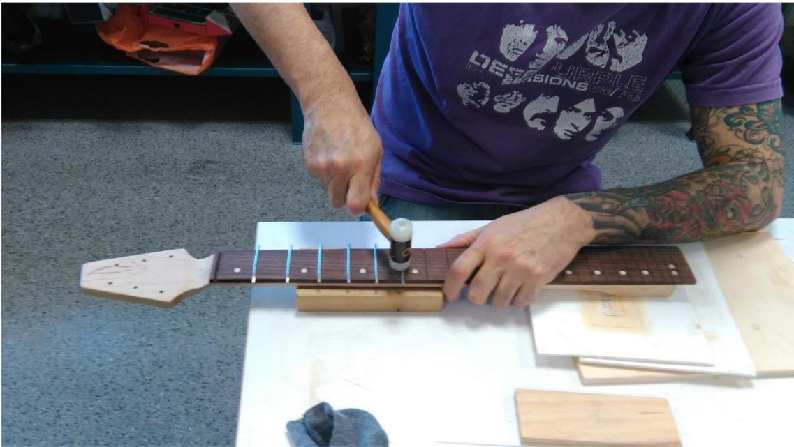
Figura 85: Ajuste de los trastes a la curvatura del diapasón
