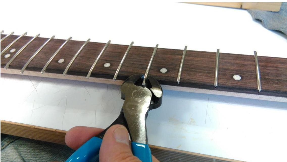
Figura 86: Corte del sobrante de los trastes
