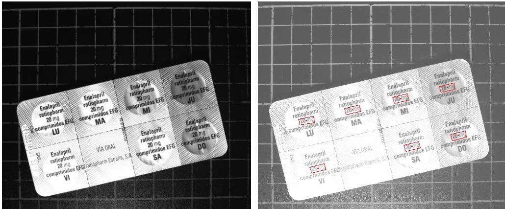
Blíster posición diagonal con 7 detecciones.
