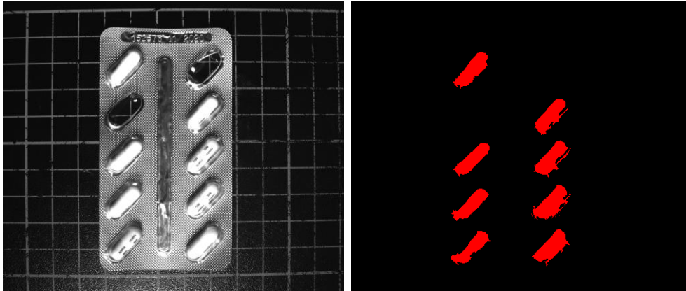
Blíster posición vertical y detección de 8 cápsulas
