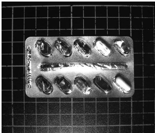
Blíster posición horizontal y detección de 2 cápsulas
