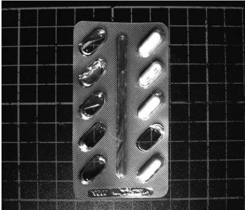
Blíster posición vertical y detección de 4 cápsulas
