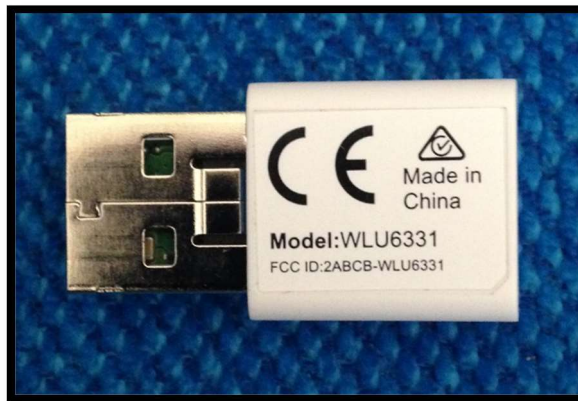
Imagen 6 y 7: Pin WiFi USB visto por ambas caras.
