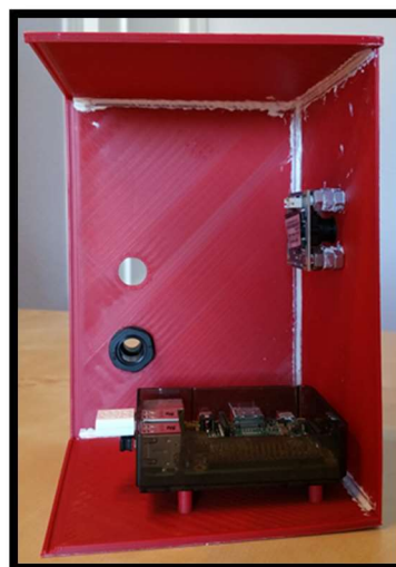
Imagen 8: Caja contenedora con los componentes en su interior antes de cablear.
