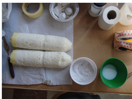
Fig. 18, probetas estucos sobre espuma de poliuretano.
