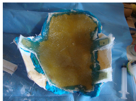
Fig. 49, positivado del molde nº1 con resina de poliéster y fibra de vidrio.
