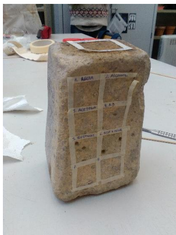
Fig.25 - Catas de limpieza físico-mecánica.
