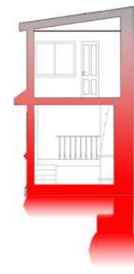
Figura 35. Representación transmisión de cargas en el cuerpo sombreado en rojo en la figura33.
