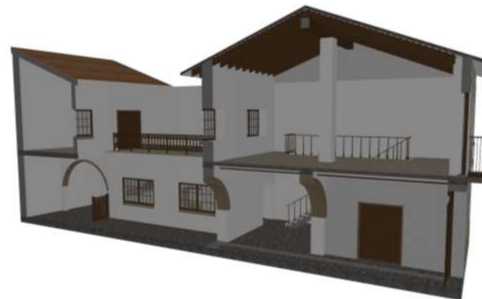
Figura 30. Sección volumétrica del estado original de la vivienda, cortado por el mismo eje que la anterior pero enfocado hacia su otro lado. Elaboración propia.
