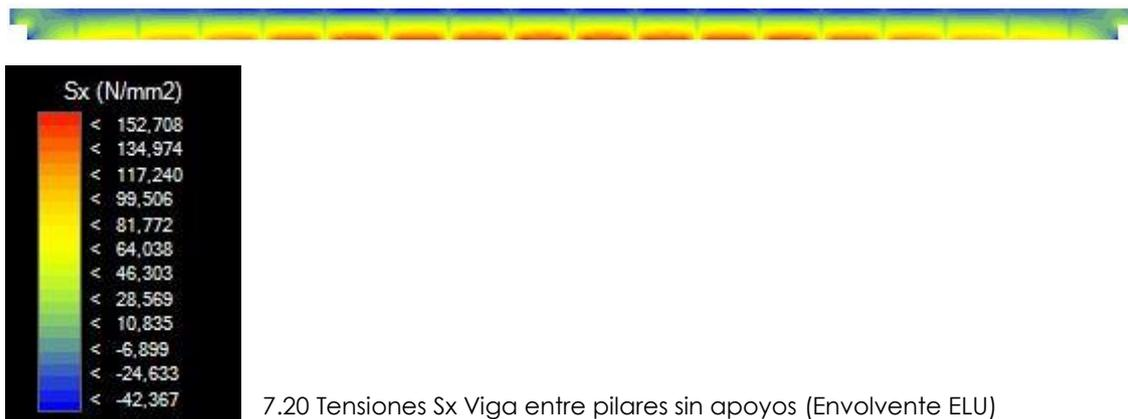
7.20 Tensiones Sx Viga entre pilares sin apoyos (Envolvente ELU)
