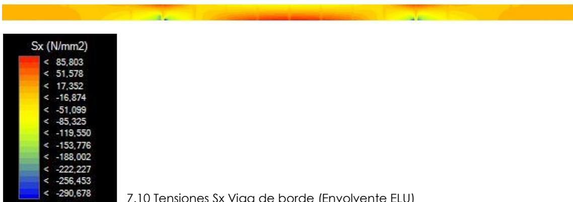
7.10 Tensiones Sx Viga de borde (Envolvente ELU)
