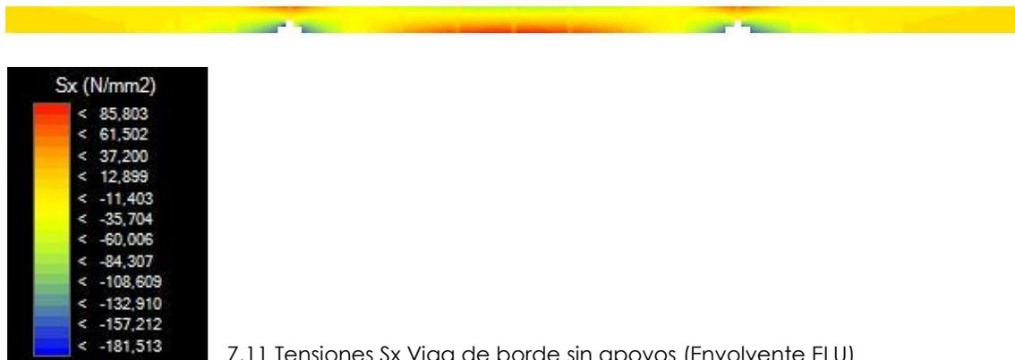
Las tensiones en la parte superior de la viga son de compresión en el centro de vano, de valor  $-74.36\text{N/mm}^2$ , y de tracción en los apoyos, llegando a  $60.36\text{N/mm}^2$ . Al contrario sucede en la parte inferior de la viga en la que las tensiones son negativas en los apoyos, con un valor de  $-181.51\text{N/mm}^2$ , y positivas en el centro del vano, con  $85.8\text{N/mm}^2$ . Las tensiones se aproximan a cero al llegar a los extremos de los voladizos en el eje de la viga.
