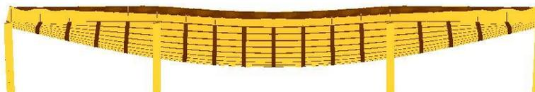
7.4 Deformación cubierta en alzado (ELS Combinación Característica: gravitatoria uso)
