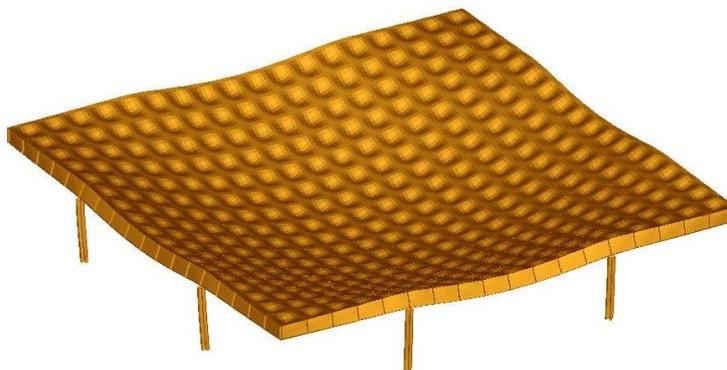
7.3 Deformación cubierta en axonometría (ELS Combinación Característica: gravitatoria uso)
