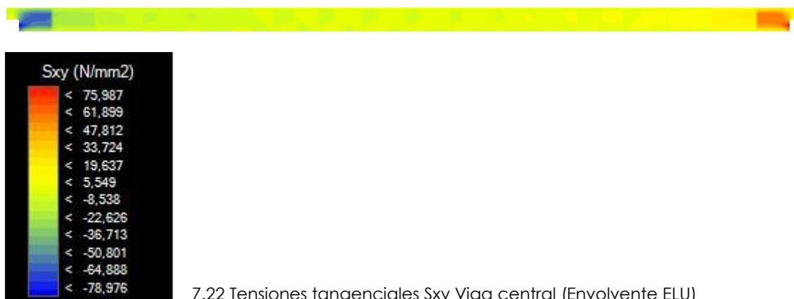
7.22 Tensiones tangenciales Sxy Viga central (Envolvente ELU)
