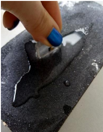
Fotografía 18. Proceso de lijado en húmedo de una de las piezas.
