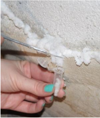
Fotografía 42. Extracción de sales para su análisis posterior.
