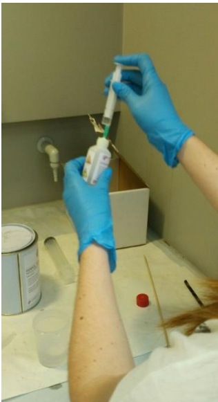
Fotografía 14. Preparación de la resina de poliéster con el catalizador.
