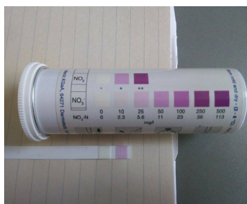
Figura 65. Resultados de los análisis de Nitratos NO 3 de las muestras de sales encontradas en el techo.
