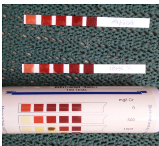
Figura 60. Resultados del análisis de Cloruros \text{Cl}^- con muestras de sales del muro norte.
