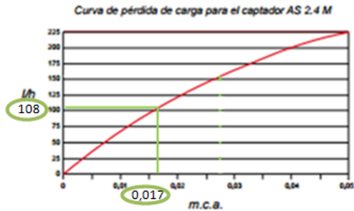
Gráfico 9. Curva pérdidas de carga del captador (Fuente: Catálogo Astersa)
