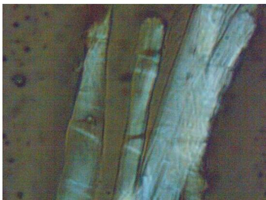
Fig 293. Microfotografía de sección longitudinal de la fibra textil. X200
