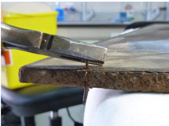
Fig 62. Extracción del clavo con alicates.
