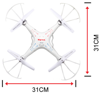
Fig.22 Vista cenital del Syma® X5C amb acotacions.
