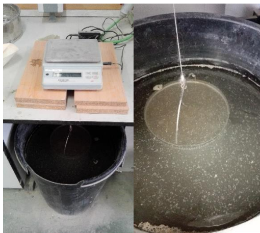
Figura 16. Introducción de cesta en tanque para toma de datos
