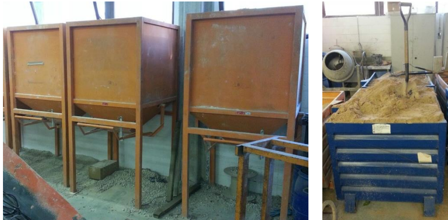
Figura 21. Silos y contenedores de áridos (izquierda) y arena (derecha)
