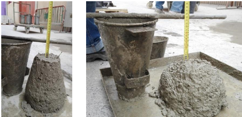
Figura 26. Realización del ensayo de consistencia por cono de Abrams
