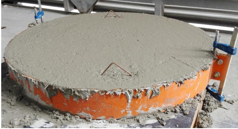
Figura 25. Molde de panel redondo con hormigón recién vertido.
