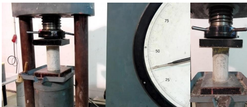
Figura 28. Prensa hidráulica empleada en los ensayos de caracterización de resistencia a compresión en probetas cilíndricas con probeta refrentada y colocada adecuadamente durante la realización del ensayo
