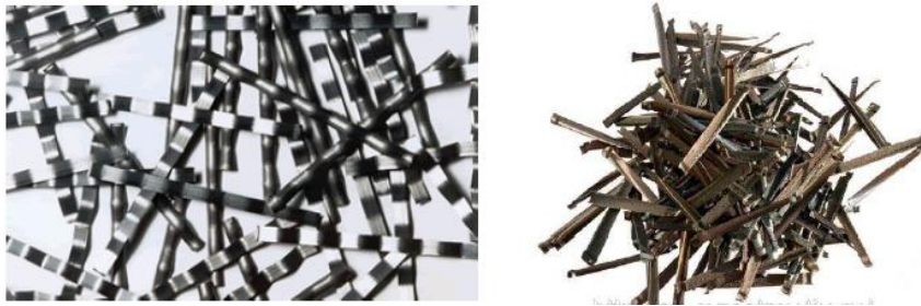
Figura 7. Fibras laminadas (Tipo II) y raspado en caliente (Tipo III) (Bekaert) [13]
