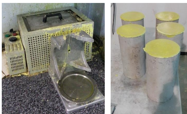
Figura 27. Máquina de refrentado de probetas cilíndricas con azufre (izquierda) y probetas cilíndricas recién refrentadas (derecha)
