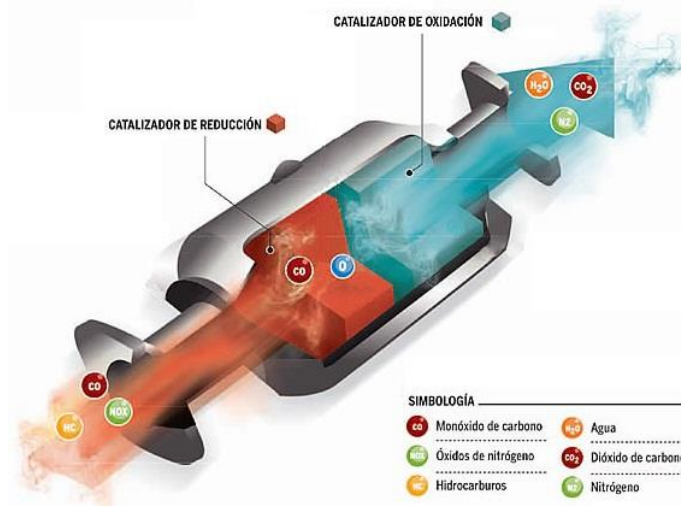
Figura 2.1: Fenómenos de reducción y oxidación de contaminantes en el interior de un catalizador
