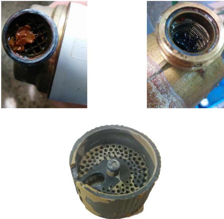
Figura 5.15. Obstrucción parcial del filtro de un contador de chorro único (izquierda), filtro en un contador volumétrico (derecha) y pistón de un contador volumétrico (centro)
