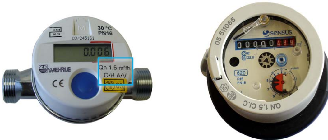
Figura 5.19. Marcado de un contador de chorro único (izquierda) y un contador volumétrico (derecha).
