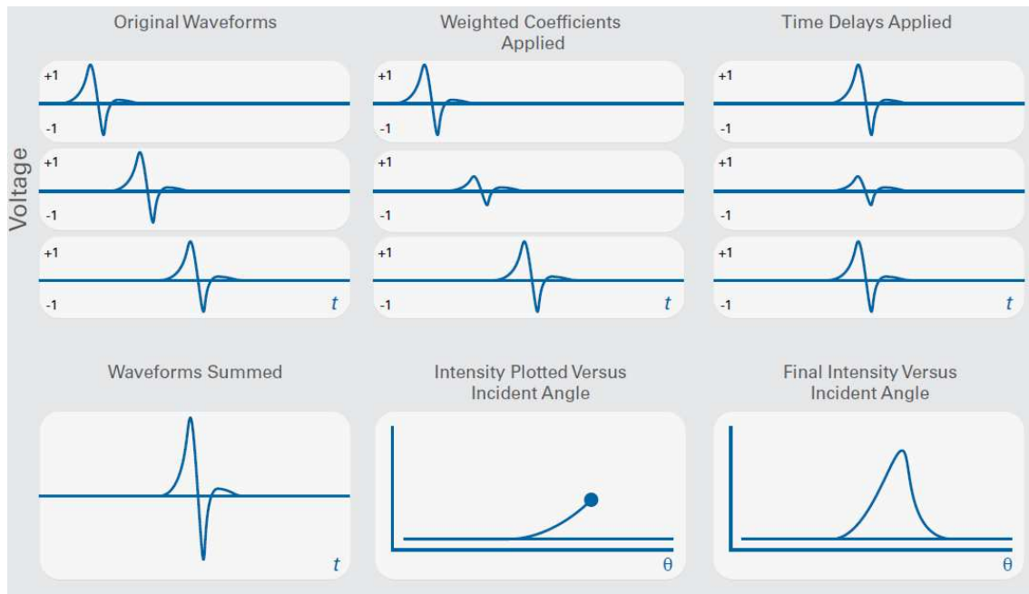
Fig. 7 Las señales se compensan por la sensibilidad de cada micrófono y se retardan entre ellas para cada uno de los ángulos a estudio.
