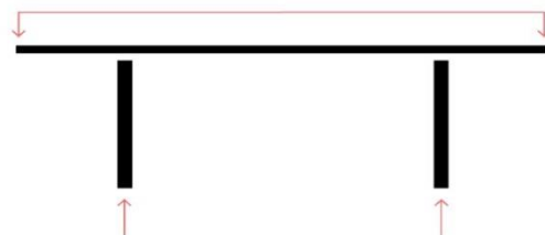
Figura 30. Esquema voladizo por prolongación
