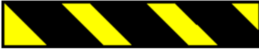
Figura 4.5.6. Señal complementaria de riesgo permanente.
