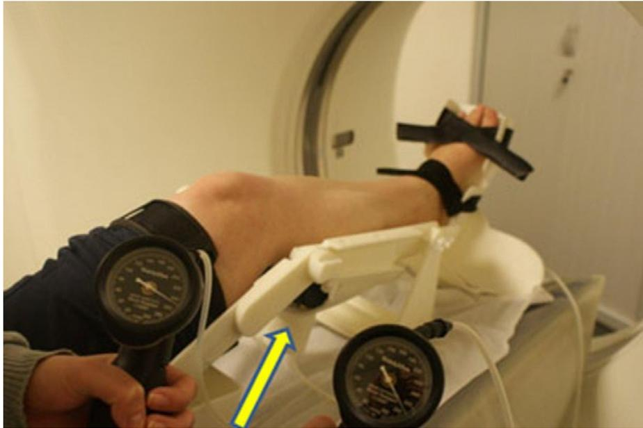
Figura 9: Porto-Knee Testing Device + Imagen por Resonancia Magnética MRI
