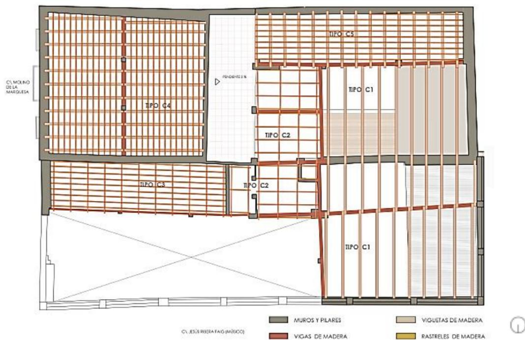
Dibujo 8. Estructura de las cubiertas del estado actual. Propio autor
