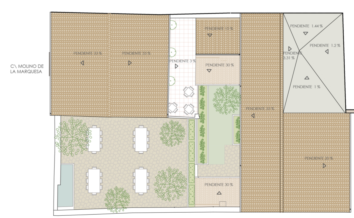
Planta cubierta. Estado propuesto. E 1/200.
