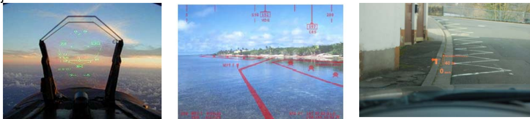
Fig A.11 Pantallas HUD con información proyectada sobre ella (A la izquierda Cabina de pilotaje de un avión, en centro cabina de un barco y a la derecha coche BMW60). Obtenido en http://en.wikipedia.org/wiki/Head-up_display
