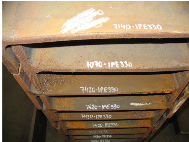
Figura 2.1- Vigas IPE330 almacenadas
