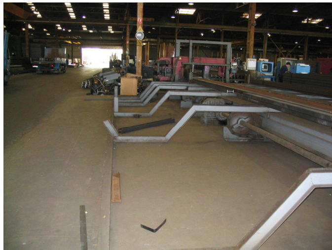
Figura 2.4- Bancadas de entrada de material
