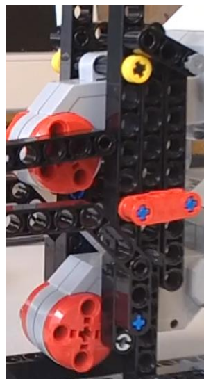
Figura 16. Detalle fijación entre motores prototipo IVO.
