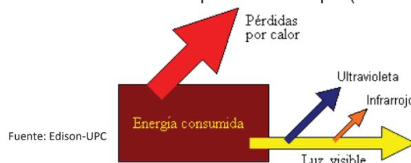
Balance energético de una lámpara de descarga
