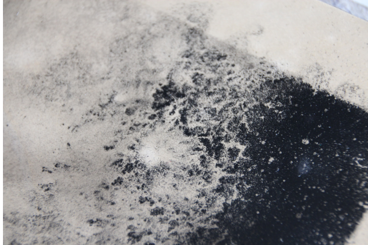
41. Detalle de partículas de hollín desplazadas por la solución de goma.
